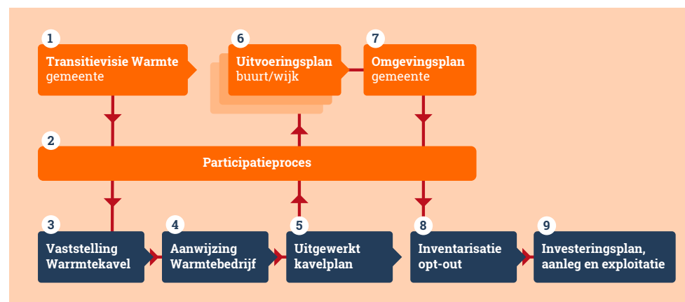
Figuur 1. De samenhang tussen het juridisch planproces (blauw) en het proces voor de realisatie van een warmtenet. (Bron: concept toelichting Wcw).
